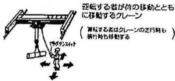
図3[床上操作式クレーン]
