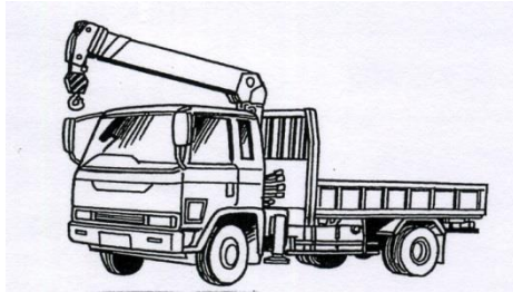
小型移動式クレーン(5t未満)の運転
